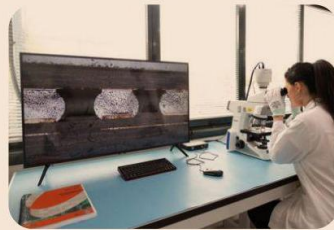
Sezione pcb al microscopio 100x
